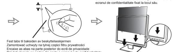
**Alternativ 2 - Bruk av tab-guides/Opcja 2 - Montaż przy użyciu uchwytów z prowadnicami/ Opção 2 - Utilizar as Abas Guia/Optiunea 2 - Utilizarea ghidajelor pentru clemă**
