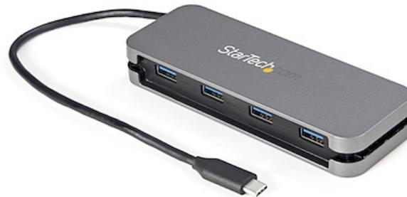
Ce hub USB-C à 4 ports vous permet de connecter quatre périphériques SuperSpeed USB 3.2 Gen 1 (5 Gb/s) à votre ordinateur portable ou fixe USB-C : la solution idéale pour ajouter des ports USB à un appareil disposant d'un nombre limité de ports USB libres. Son système d'enroulement pratique permet de ranger le câble intégré pour une portabilité optimale.
