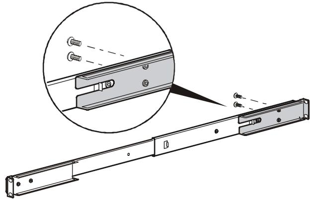
2. Repositionnez le support de montage arrière en le faisant glisser jusqu'à la languette avant du rail de fixation.
