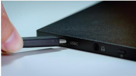
Le transfert de vidéos via USB-C permet à ce moniteur Philips d'afficher des vidéos haute résolution provenant de votre appareil. Le câble USB double tresse fin et réversible est équipé de connecteurs de type C et A, ce qui lui permet non seulement de transmettre des vidéos, mais également de simplifier les partages et présentations. Vous pouvez charger facilement ce moniteur sur votre ordinateur portable au moyen d'un unique câble USB-C.
