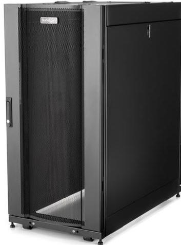
Ce rack de serveur 25U fournit une armoire sécurisée et élégante, pour le stockage d'appareils de 19" à montage en rack, tels que les serveurs Dell, HP et IBM ainsi que des équipements de télécommunication et audio/vidéo. Ce rack est compatible avec les équipements conformes à la norme EIA-310 et supporte une capacité de charge totale de 1 500 kg.
